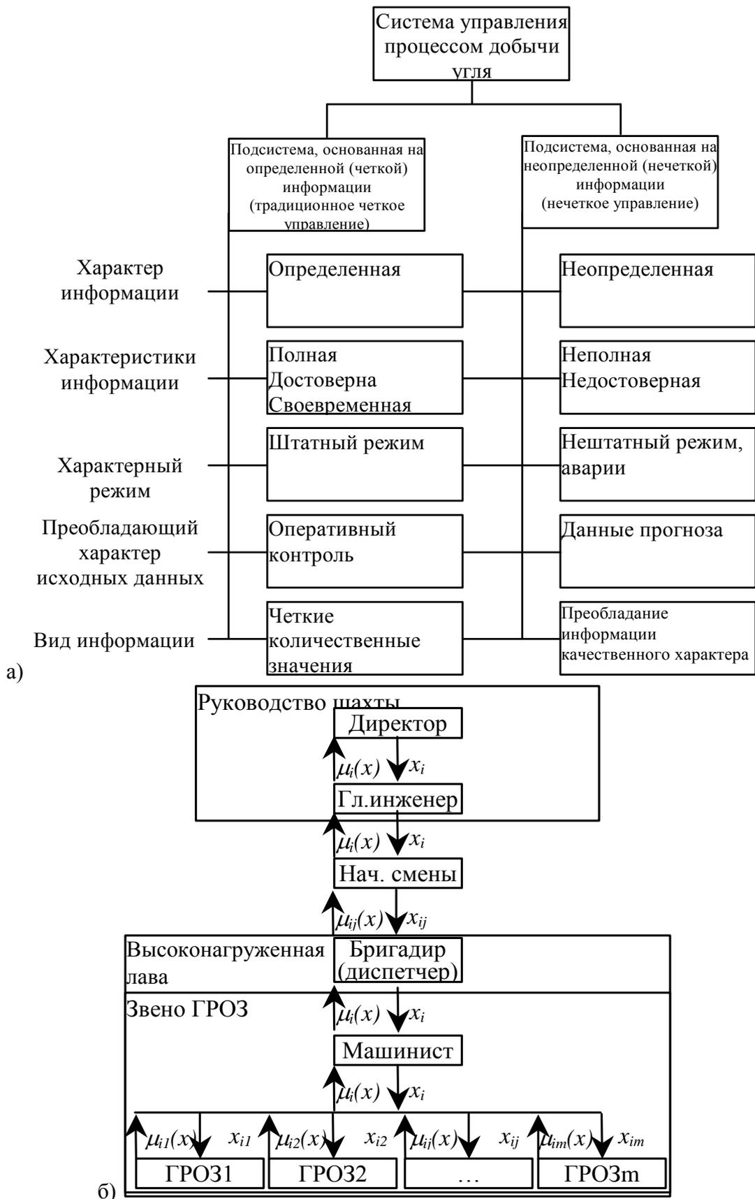
Рис. 1 – Основные характеристики комбинированной системы управления процессом добычи угля (а) и схема процесса принятия решений в условиях неопределенной информации (б)
